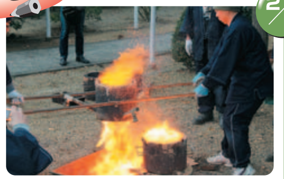
伝統的な手法で砂鉄や木炭から鉄や鋼を作り出す「たたら製鉄」の公開実演が金物資料館横(上の丸町)で行なわれました。鉄や鋼の元となる鉞 くわ を約7kg取り出すことができました。
